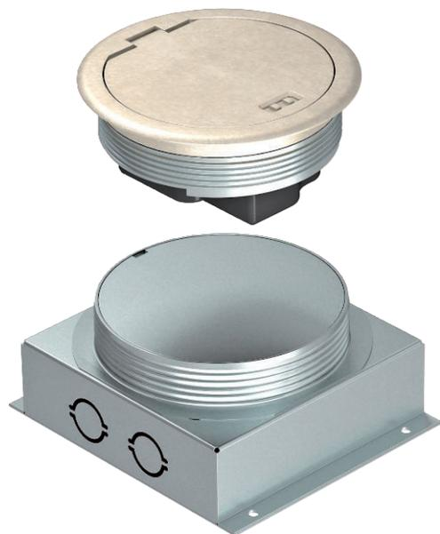
Tampa redonda com estrutura de proteção do pavimento e caixa de pavimento UDL2-120 para montagem em chão de betonilha em áreas interiores. Tampa com uma tomada Schuko simples com alvéolos inclinados a 33°. Lateralmente, perto da tomada existe espaço para instalar, opcionalmente, até 2 conectores de dados. No estado fechado, a tampa pode ser limpa a húmido. A profundidade mínima de montagem é de 70 mm. Superfície niquelada.
