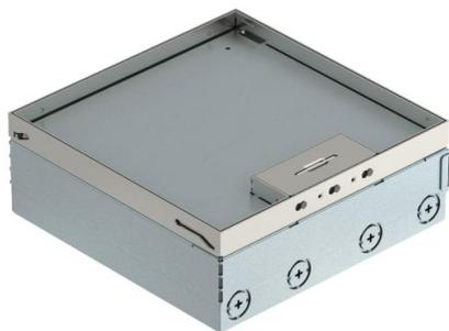
Caixa de pavimento quadrada para utilização em chão falso de limpeza a seco e betonilha em áreas interiores. Caixa com aberturas de entrada para tubos (M25). Tapa ajustável ao rebordo superior do revestimento do pavimento, através de 4 apoios de nivelamento. A profundidade mínima de montagem é de 95 mm, a amplitude de nivelamento + 30 mm.
