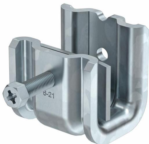
Este tipo de clip de suspensão é encaixado no apoio e fixo à viga ou ferro plano usando uma placa de pressão e um parafuso (M8). O parafuso hexagonal tem um WAF de 10 mm. No clip estão também incorporadas duas roscas M8 adicionais para, por exemplo, fixar um varão roscado.
