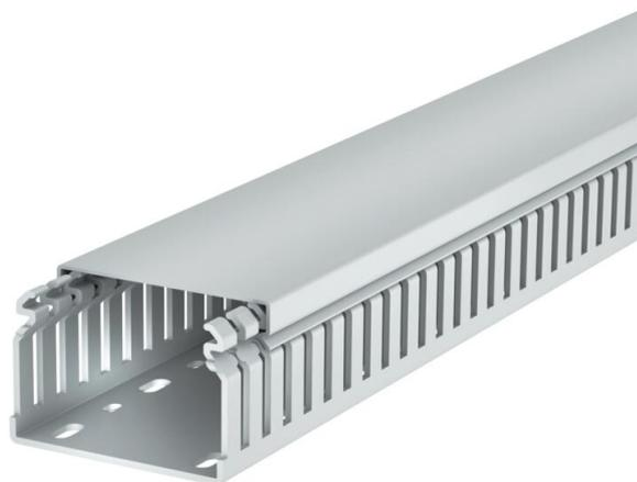
Calha de cablagem livre de halogéneos conforme a norma DIN EN 50085-2-3, inclui tampa e base perfurada para colocação horizontal e vertical de cabos e linhas elétricas no quadro de distribuição. Versão de calha DIN. A quebra das barras pode ocorrer sem ferramentas. A execução no pavimento é possível através de pontos de rutura nominais. Testado de acordo com a DIN EN 50085-2-3. Comprimentos especiais disponíveis mediante pedido.
