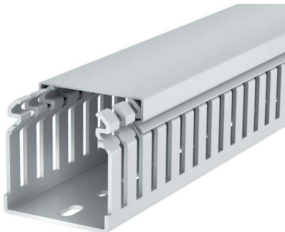
Calha de cablagem livre de halogéneos conforme a norma DIN EN 50085-2-3, inclui tampa e base perfurada para colocação horizontal e vertical de cabos e linhas elétricas no quadro de distribuição. Versão de calha DIN. A quebra das barras pode ocorrer sem ferramentas. A execução no pavimento é possível através de pontos de rutura nominais. Testado de acordo com a DIN EN 50085-2-3. Comprimentos especiais disponíveis mediante pedido.
