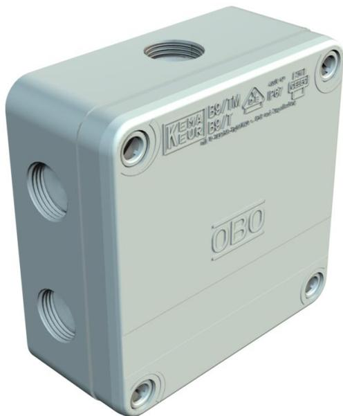
A caixa de derivação para espaços húmidos B9 / T...: consiste em dois componentes plásticos diferentes e livres de halogéneos, com membrana de perfurável (para cabos com diâmetros de até 15 mm) na área inferior.
