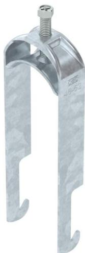
Abraçadeira BBS com tipo W, placa de pressão metálica com arestas arredondadas para proteção de cabos. Para montagem vertical e horizontal de 2 cabos individuais em ferros angulares até < 40 mm. Com parafuso simples na placa de pressão, cabeça de parafuso hexagonal universal tam. 10, com fenda e fenda em cruz. Adequada para montagem em áreas interiores e exteriores. Recomenda-se o uso de uma contraplaca.
