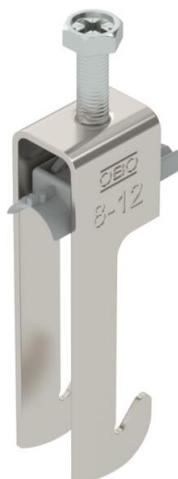
Abraçadeira BBS tipo W, placa de pressão em plástico de polipropileno. Para montagem vertical e horizontal de 1 cabo individual em ferros angulares até < 40 mm. Com parafuso simples na placa de pressão, cabeça de parafuso hexagonal universal tam. 10, com fenda e fenda em cruz. Adequado para montagem em áreas interiores e exteriores. Recomenda-se o uso de uma contraplaca.
