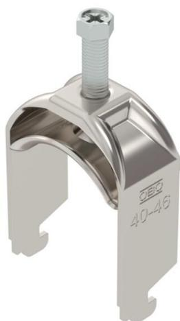
Abraçadeira BBS tipo N, placa de pressão metálica com arestas arredondadas para proteção de cabos. Para montagem vertical e horizontal de 1 cabo individual em perfil C. Para largura de rasgo 11 - 12 mm. Com parafuso simples na placa de pressão, cabeça de parafuso hexagonal universal tam. 10, com fenda e fenda em cruz. Adequado para montagem em áreas interiores e exteriores. Recomenda-se o uso de uma contraplaca.
