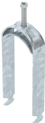
Abraçadeira BBS tipo cabeça de martelo, placa de pressão metálica com arestas arredondadas para proteção de cabos. Para montagem vertical e horizontal de 2 cabos individuais em perfil C. Para largura de rasgo 16 - 17 mm. Com parafuso simples na placa de pressão, cabeça de parafuso hexagonal universal tam. 10, com fenda e fenda em cruz. Adequado para montagem em áreas interiores e exteriores.. Vários cabos devem ser separados por placas duplas. Recomenda-se o uso de uma contraplaca.
