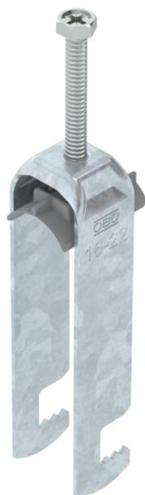
Abraçadeira BBS tipo F, placa de pressão em plástico de polipropileno. Para montagem vertical e horizontal de 3 cabos individuais em ferros planos. Com parafuso simples na placa de pressão, cabeça de parafuso hexagonal universal tam. 10, com fenda e fenda em cruz. Adequada para montagem em áreas interiores e exteriores. Vários cabos devem ser separados por placas duplas. Recomenda-se o uso de uma contraplaca.
