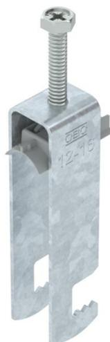
Abraçadeira BBS tipo F, placa de pressão em plástico de polipropileno. Para montagem vertical e horizontal de 3 cabos individuais em ferros planos. Com parafuso simples na placa de pressão, cabeça de parafuso hexagonal universal tam. 10, com fenda e fenda em cruz. Adequada para montagem em áreas interiores e exteriores. Vários cabos devem ser separados por placas duplas. Recomenda-se o uso de uma contraplaca.
