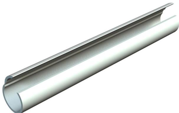
Tubo aberto Quick-Pipe de plástico para instalação à superfície de cabos e tubos em áreas interiores e áreas exteriores protegidas. Montagem em parede e teto com abraçadeira Quick, abraçadeira Star-Quick e abraçadeira Multi-Quick. Fecho e abertura sem ferramentas, girando na abraçadeira. Aplicável na amplitude de temperaturas de - 25° a + 60 °C.
