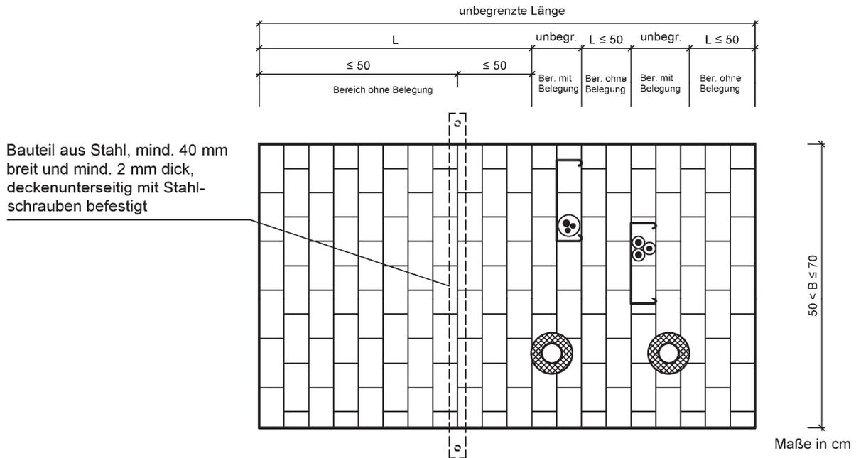
Bei Einbau in Öffnungen in massiven Decken (s. Anlagen 14 - 16) mit einer Breite  $50 \text{ cm} < B \leq 70 \text{ cm}$ , muss in Abschottungen ohne Belegung bzw. in Bereichen ohne Belegung mit einer Länge  $L > 50 \text{ cm}$  eine der folgenden Maßnahmen erfolgen (vgl. Abschnitt 2.5.2.5.6):
