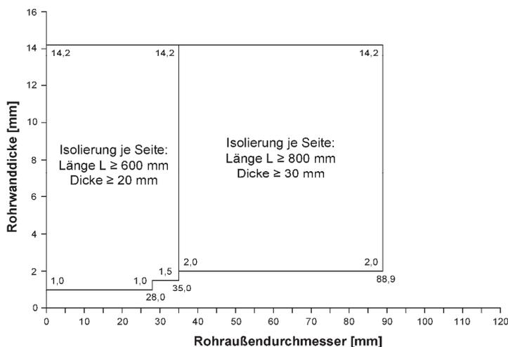
\*) Bei Einbau in nichttragende, raumabschließende Wandkonstruktionen gem. Abschnitt 2.2.1, Tab. 3, sind nur Rohre mit  $\varnothing \leq 35$  mm zulässig (s. Anlage 2).
