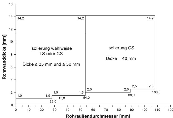
\*) FOAMGLAS der Deutsche FOAMGLAS GmbH; Verklebung der Rohrschalen mit Kleber PC 18 und Sicherung durch zwei Spannbänder je Seite in 10 cm bzw. 40 cm Abstand zur Schottoberfläche
