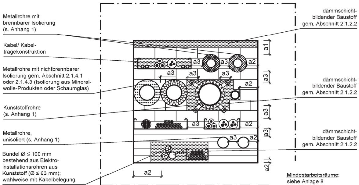
Teilbereiche zwischen Installationen sowie zwischen Installationen und den Öffnungslaibungen können bis zu einer Größe von maximal 450 mm x 500 mm (Breite x Höhe) oder 0,225 m<sup>2</sup> mit dem dämmschichtbildenden Baustoff gem. Abschnitt 2.1.2.2 ausgefüllt werden. Spalte zwischen Brandschutzblöcken gem. Abschnitt 2.1.1 und Öffnungslaibung können bis zu einer Breite von 60 mm verschlossen werden.
